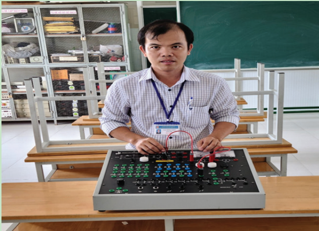
Hình 2: Mô hình Đo lường các đại lượng điện cơ bản thực tế
