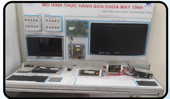
Mô hình thực hành sửa chữa máy tính ít sử dụng để hư hỏng
