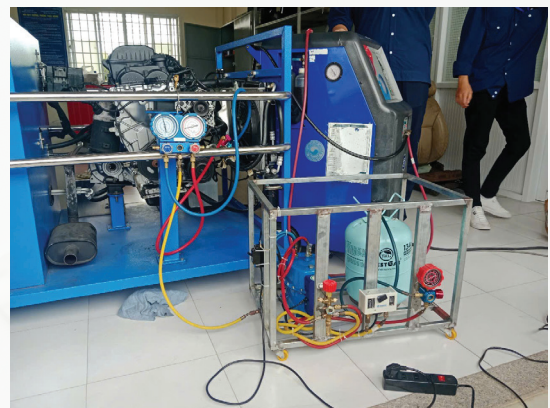
Hình 3. Hình ảnh quá trình hút ga bằng máy thu hồi ga
