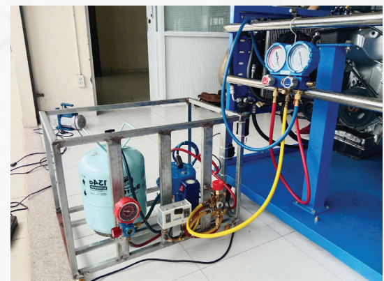
Hình 4. Nạp ga bằng máy thu hồi ga
