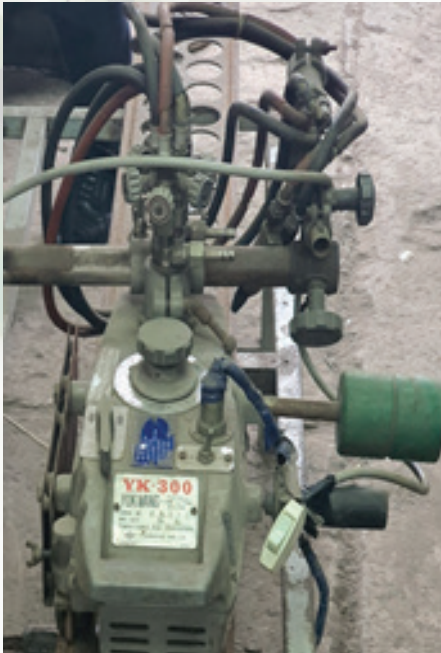
Hình 2. Thiết bị cắt con rùa gió đá (Acetylen + Oxy) tự động YK-300 của YUKWANG
